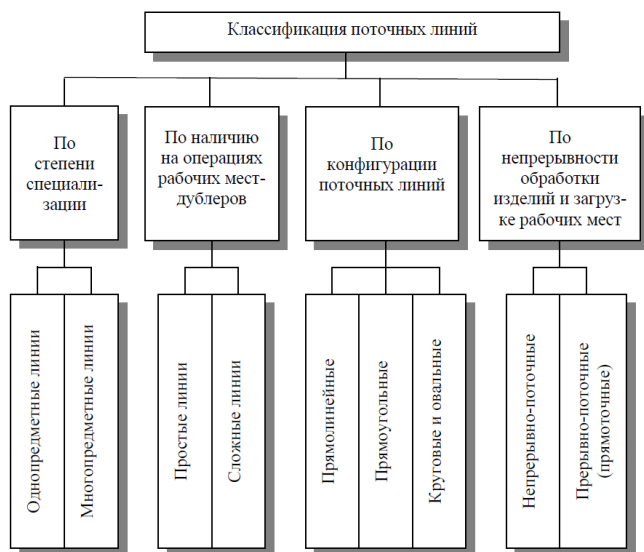
Рисунок 1 – Основные разновидности поточных линий в промышленности
